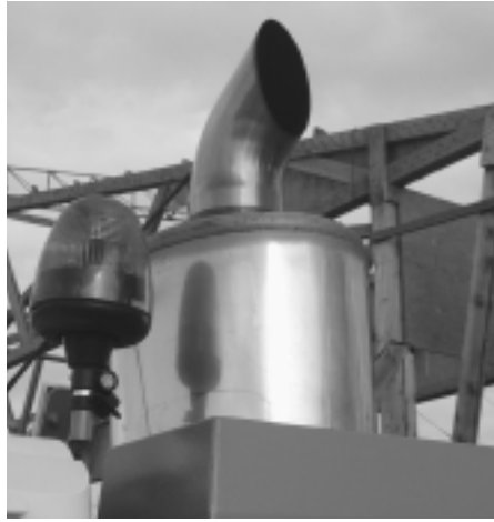
A gauche: «precycling» à l'instar des pieux extraits à Neuchâtel. Déjà d'occasion, ils ont encore été réutilisés après Expo.02. A droite: les machines de chantier ont été équipées de filtres à particules (Photos: A. Stuber).
