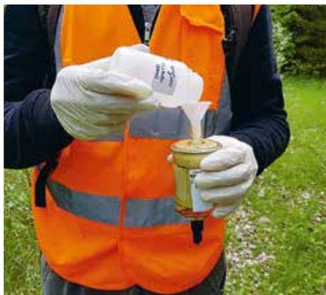
Entnahme einer Wasserprobe vor Ort mit dem Kit der Firma Spygen.
