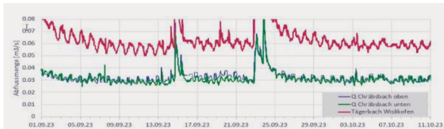
Abflussganglinien an zwei Stellen im Chräbsbach bei Siglistorf und im Tägerbach bei Wislikofen vom 1.9. bis 11.10.2023. Vom 13.-23.9.2023 führt der Chräbsbach an der oberen Messstelle mehr Wasser als bei der unteren Messstelle, da ein kleiner Teil des Wassers in dieser Zeit mutmasslich zwischen den Messstellen versickert und damit das Grundwasser anzureichern vermag.
